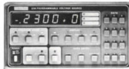
Programmeerbare spanningsbron van 50µV - 100V met standaard IEEE bus-interface, 100 punten geheugen en digitale I/O.
