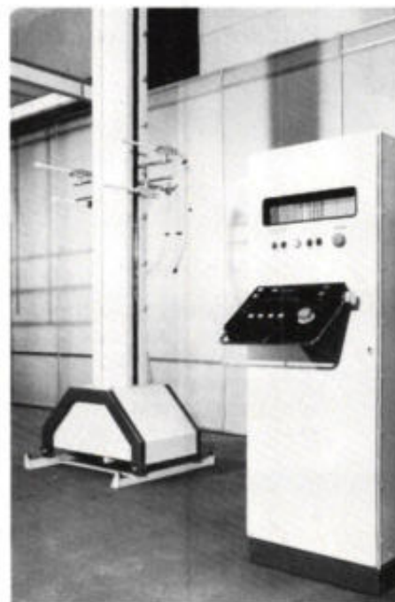
Afb. 8. Robot met micro-elektronische besturing voor lineaire spuitwerkzaamheden, gefabriceerd door LEW.
